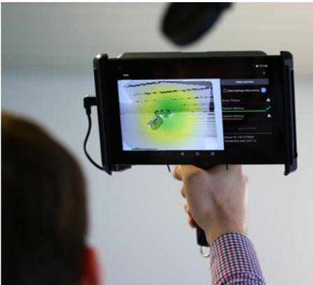
Der 3D-Handscanner eignet sich ideal zum Aufnehmen von Verteileraufbauten, kleineren Räumen und weiteren Objekten. Sein geringes Gewicht und die einfache Bedienung erlauben in jeder Situation präzise 3D-Aufnahmen.
